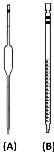
Figura 2.1 – Tipos de pipetas: em (A), uma pipeta volumétrica de uma faixa (medição exata); e, em (B), uma pipeta graduada de duas faixas (esgotamento total).
